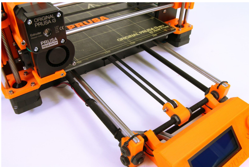
Obr. 32 - Správně napnutý řemen pod vyhřívanou podložkou
