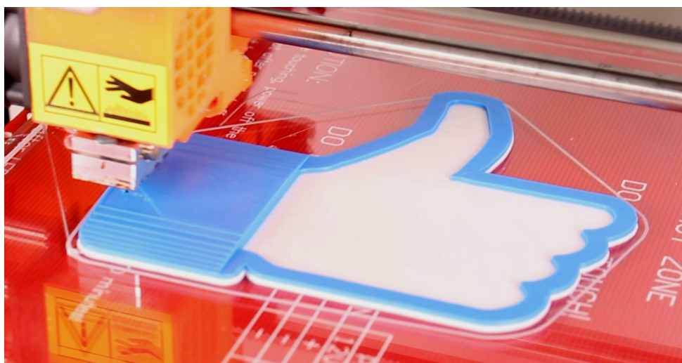
Obr. 21 - Vícebarevný objekt tisknutý pomocí Colorprintu
