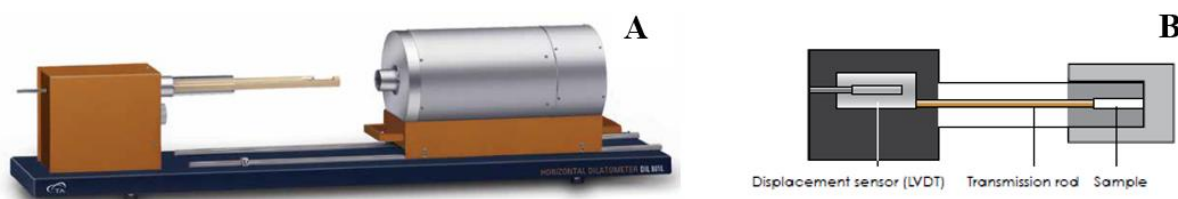
Obr. 5.10 Dilatometr v provedení push-rod (A) a znárodnění principu této metody (B) [5.23]
