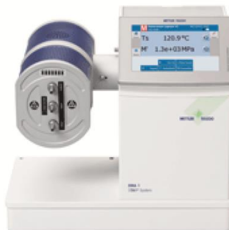
Obr. 4.10 Testovací zařízení pro dynamické zkoušky
