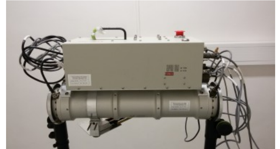
přenosný fúzní neutronový generátor 14 MeV neutronů (fúze deuteria a tritia) produkce: 10^8 neutronů/s
